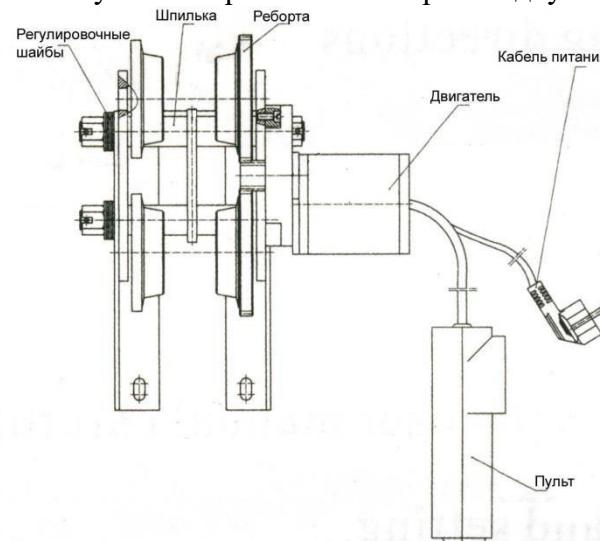
5.6 С помощью двух шпилек и регулировочных шайб установите ролики так, чтобы зазоры между ребордами роликов и кромками полок двутавра были в пределах от 2-х до 4-х мм.
